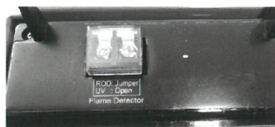
背面部 : センサー切り替えジャンパー
